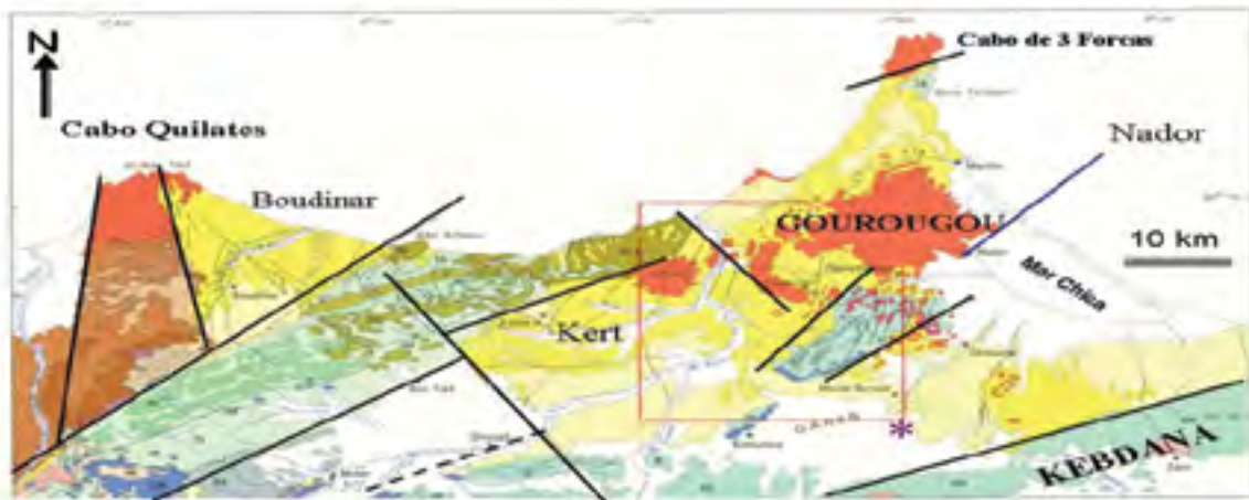
Figura 2- Esquema estructural geológico del Rif oriental. Las fallas más importantes se indican en característica negras oscuras. La estrella indica el epicentro del sismo de 2004 (in Azdimousa, A. 1991).
